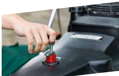
CENTRALE BORSTEL HOOGTE VERSTELLING
